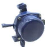
双向拉绳开关安装于皮带输送机的两侧，用钢丝绳沿着输送机将开关链接起来。当输送机需要紧急制动时，可在现场任意处拉动钢丝绳，拉杆受力旋转，通过传动轴使凸轮发生位移，驱动微动开关切断控制线路，输送机停止运行。
